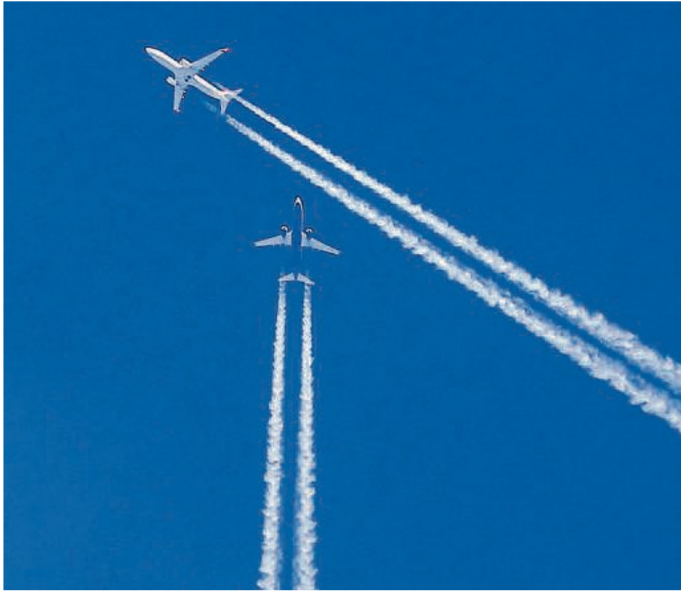
Die klimaschädlichen Kondensstreifen, die Flugzeuge zumeist hinterlassen, entstehen dadurch, dass Flugzeug-Triebwerke Rußpartikel ausstoßen.
