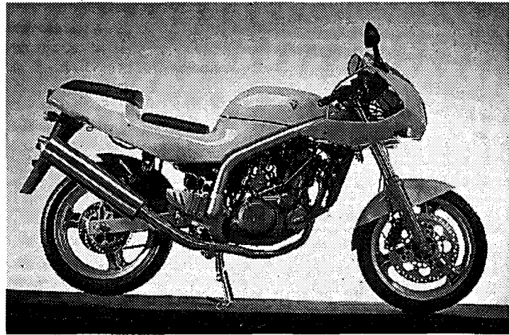
170 kg stellt die Skorpion Sport auf die Waage, beflügelt vom 660-ccm-Einzylinder von Yamaha mit 48/34 PS. (nh)
